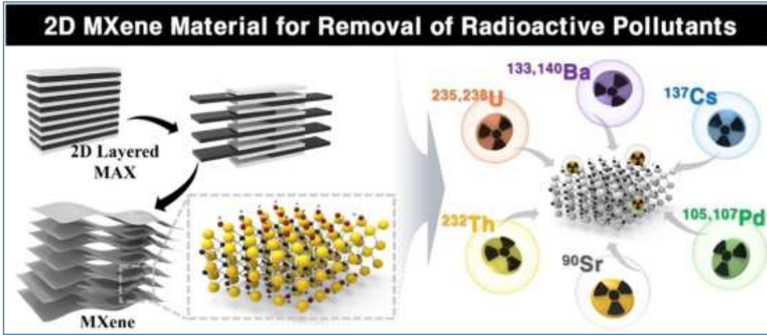
الشكل (III-4): يوضح رسم تخطيطي لعدة معادن ثقيلة تمت إزالتها بواسطة MXene.
