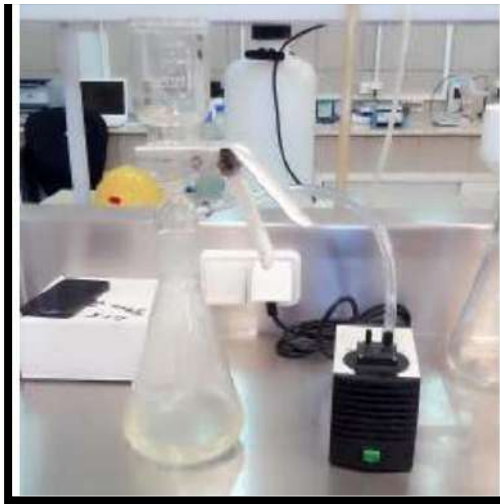
Figure.6 : Dispositif de filtration sous vide.
