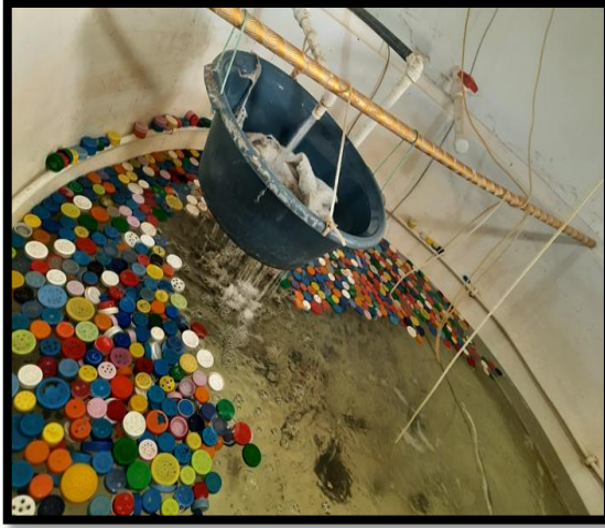
الشكل 3.IV: تنقية الماء المستعمل في أحواض الأسماك بواسطة الكربون النشط
