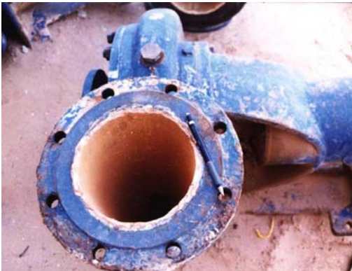
Photo.02. entartrage au niveau des équipements du réseau de distribution.
