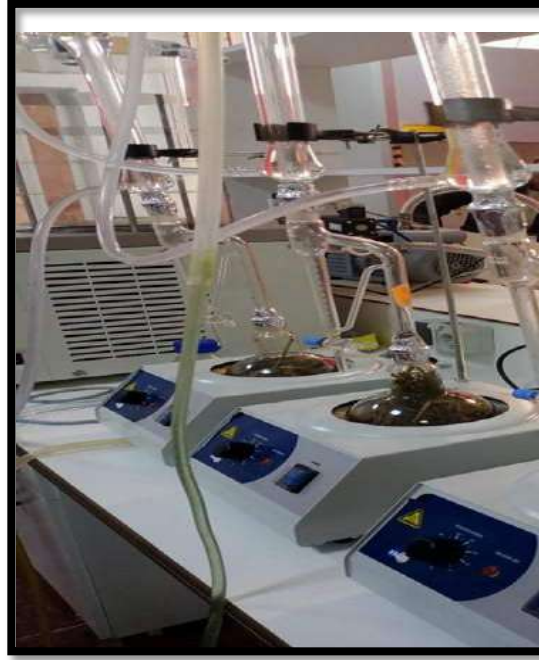
الشكل(III-03): جهاز Clevenger المستخدم لاستخلاص الزيت العطري.
