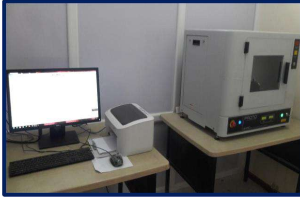
الشكل (2-8): صورة لجهاز انعراج الاشعة السينية المستعمل في دراسة العينات
