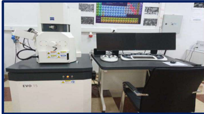
الشكل (2-10): صورة لجهاز المجهر الالكتروني الماسح المستعمل.
