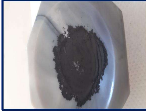
شكل (2-3): المسحوق المتجانس بعد عملية المزج والسحق (LEVRES).
