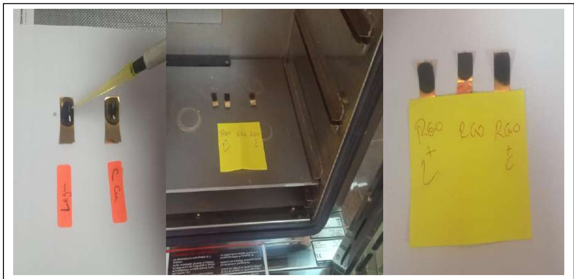
Figure II.12: Étapes de séchage de la solution colloïdal sur papier d'or
