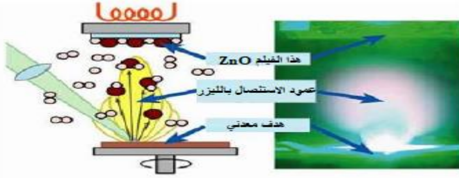
الشكل (9.II) يوضح عملية الاقتلاع بالليزر. [13]
