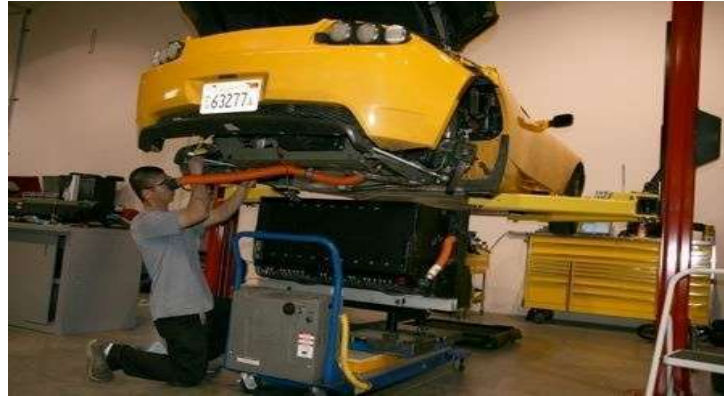
Figure II.14. Installation du pack de batteries au lithium-ion à bord du Roadster de Tesla
