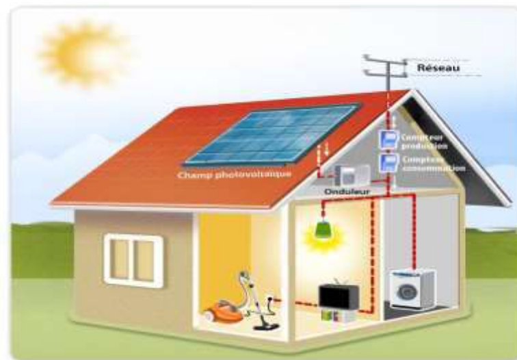
Figure I.18. Système connecté au réseau
