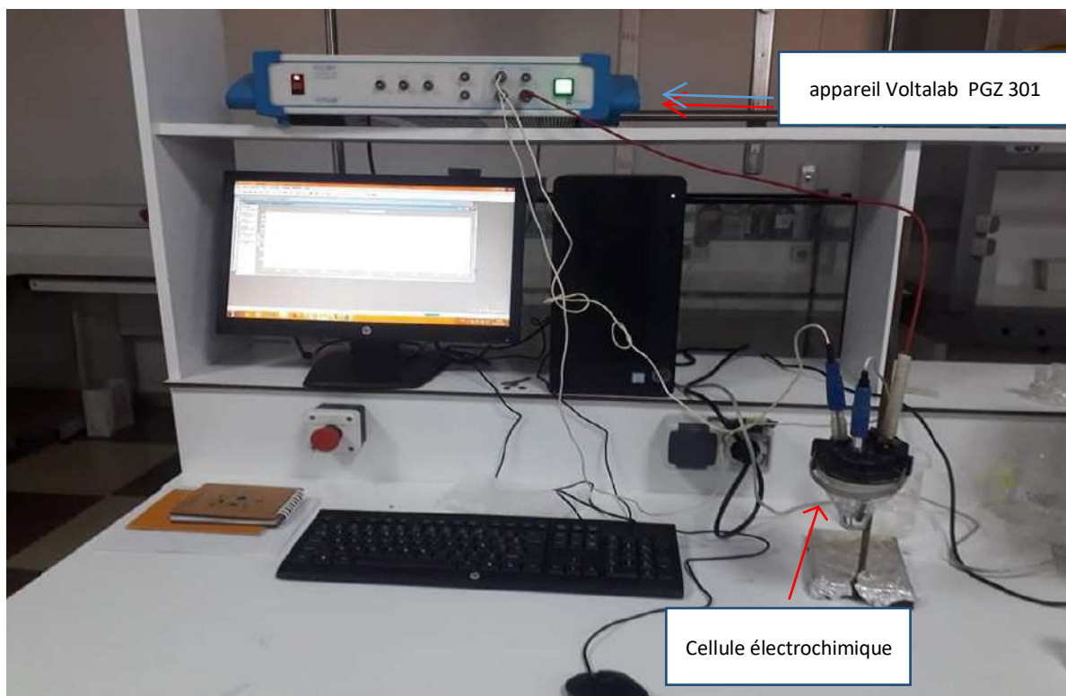
Figure II.3 : Photo de montage expérimentale du système électrochimique
