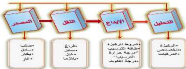
الشكل (III-1): رسم تخطيطي يوضح خطوات ترسيب الأغشية الرقيقة [2]
