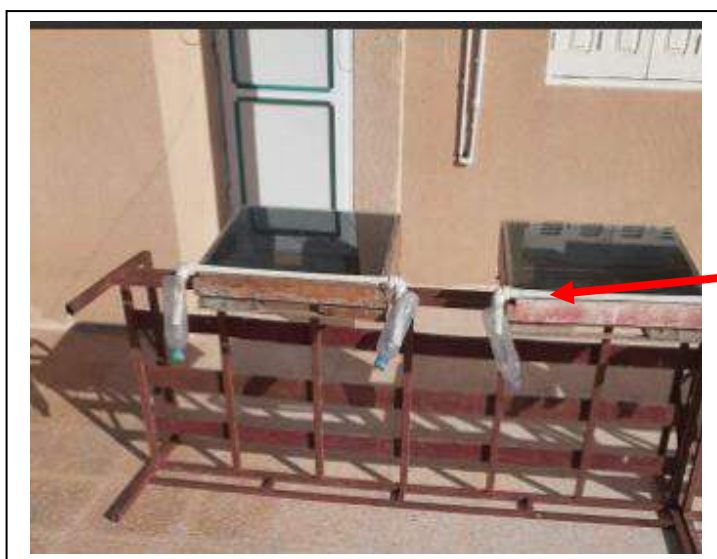
الشكل (3-3) صورة فوتوغرافية للياف النخيل داخل المقطر
