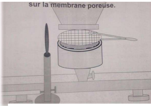
صورة 19: طريقة وضع الفلتر الورقي فوق الداعمة المسامية
