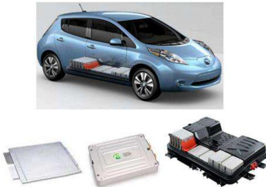
**Figure I.10 :** Pack de batterie Li-ion de 24kWh pour le véhicule électrique Nissan LEAF.
