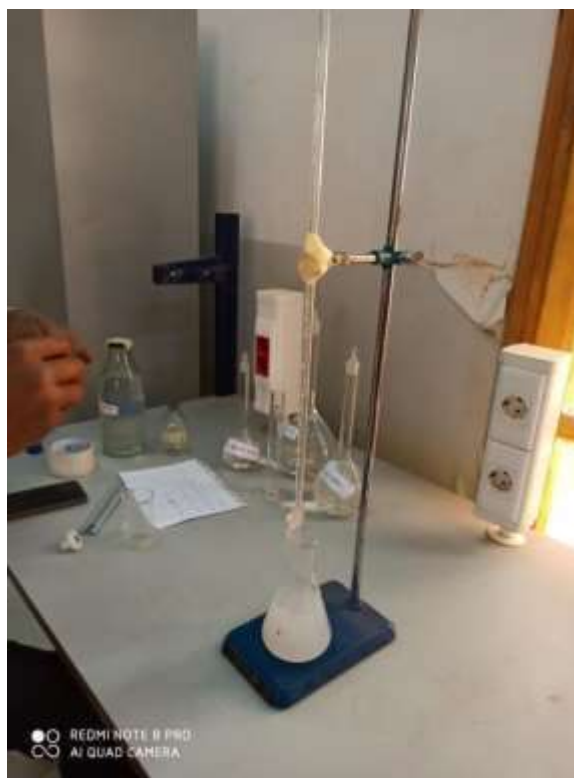
Les Figure N°20: Titrage de la solution Thiosulfate de sodium
