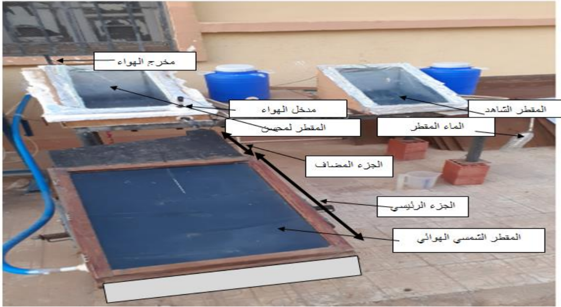
الشكل (2-4): صورة توضح كيفية تجهيز التجربة الثانية (اللاقط الشمسي مغلق)
