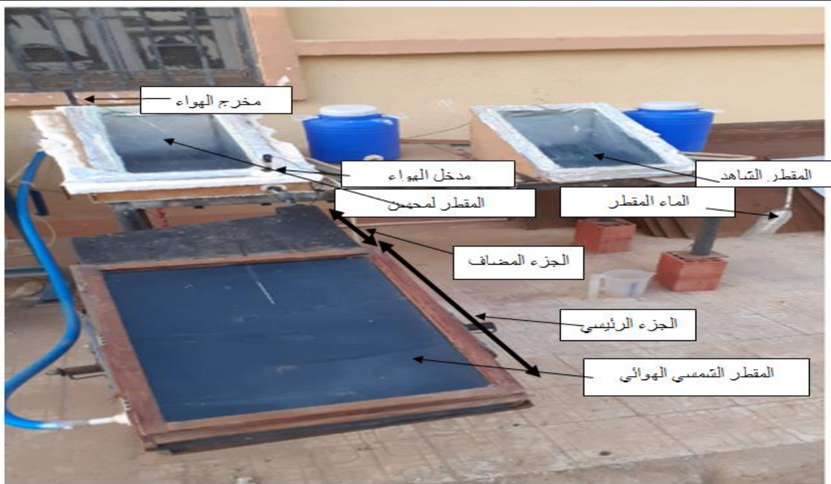
الشكل (2-2): صورة توضح كيفية تجهيز التجربة الأولى (اللاقط الشمسي مفتوح)
