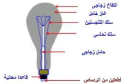
الشكل (6-II): مكونات المصباح المتوهج
