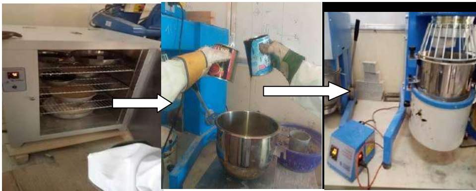
Agrégats et bitume dans l'étuve de chauffage & Opération de malaxage
