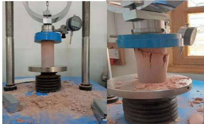
Figure III - 1: Une éprouvette de compression pendant l'écrasement
