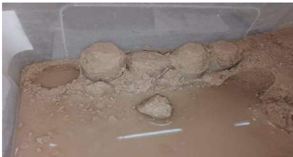
Figure III - 10: Des éprouvettes de compression des mélanges après 28 j+04j d'immersion dans l'eau Mode 01
