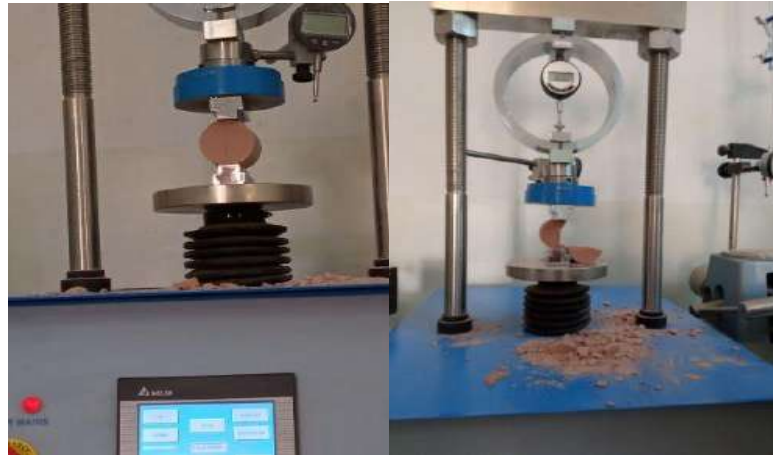
Figure III -12: Une éprouvette de Traction pendant l'écrasement.
