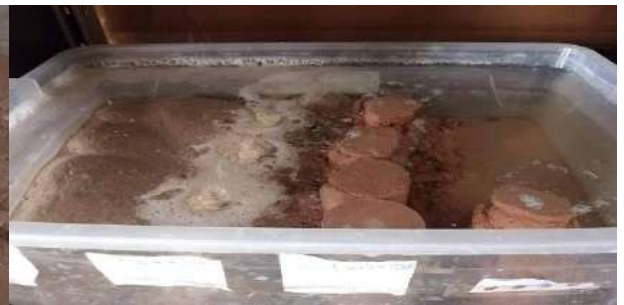
Figure III - 11: Des éprouvettes de compression des mélanges après 28 j+04j d'immersion dans l'eau Mode 02
