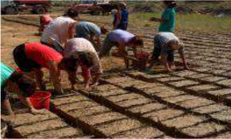
صورة (7.1): التقنية اليدوية لتشكيل الطوب النيئ في قوالب من خشب [12]
