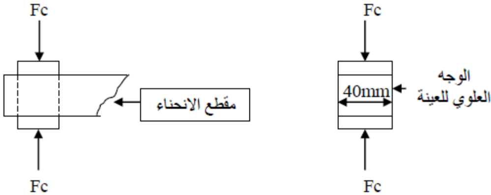
الشكل (4.IV): رسم تخطيطي يوضح تجربة الضغط.
