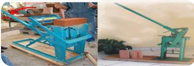
صورة(3.1): طوب أرضي مضغوط مصنوع باستخدام مكبس يدوي[9]
