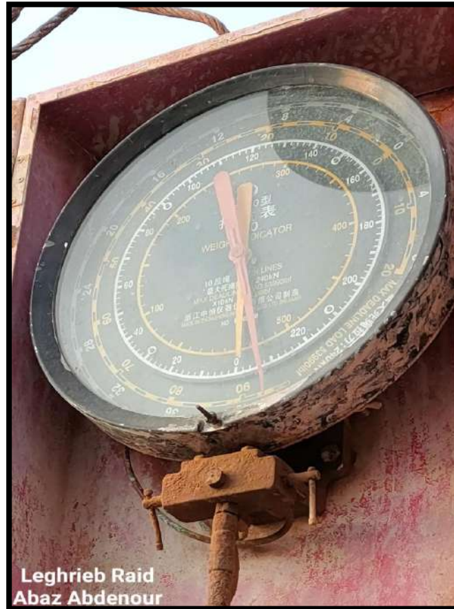
Photo N°1: Indicateur de poids ( Martin Decker).
