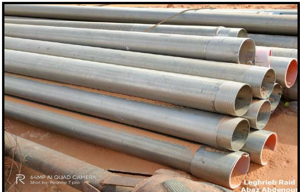
Photo N°29: Tube plein Acier Inox 8 5/8 ".
