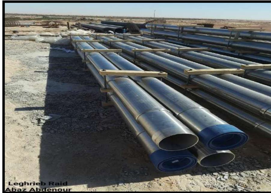
Photo N°35: Les crépines Johnson inox slot 20.
