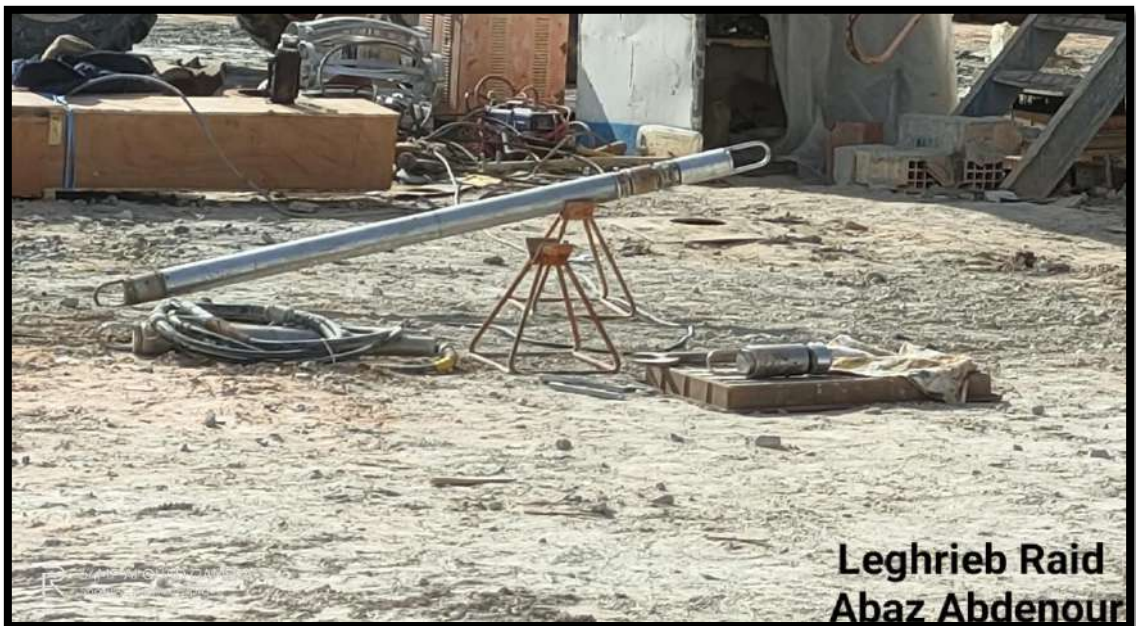
Photo N°25: Sonde combinée (Gamma ray , polarisation spontanée , résistivité électrique ...).
