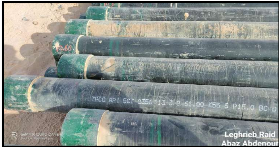
Photo N°28: Le tubage 13 3/8 API.
