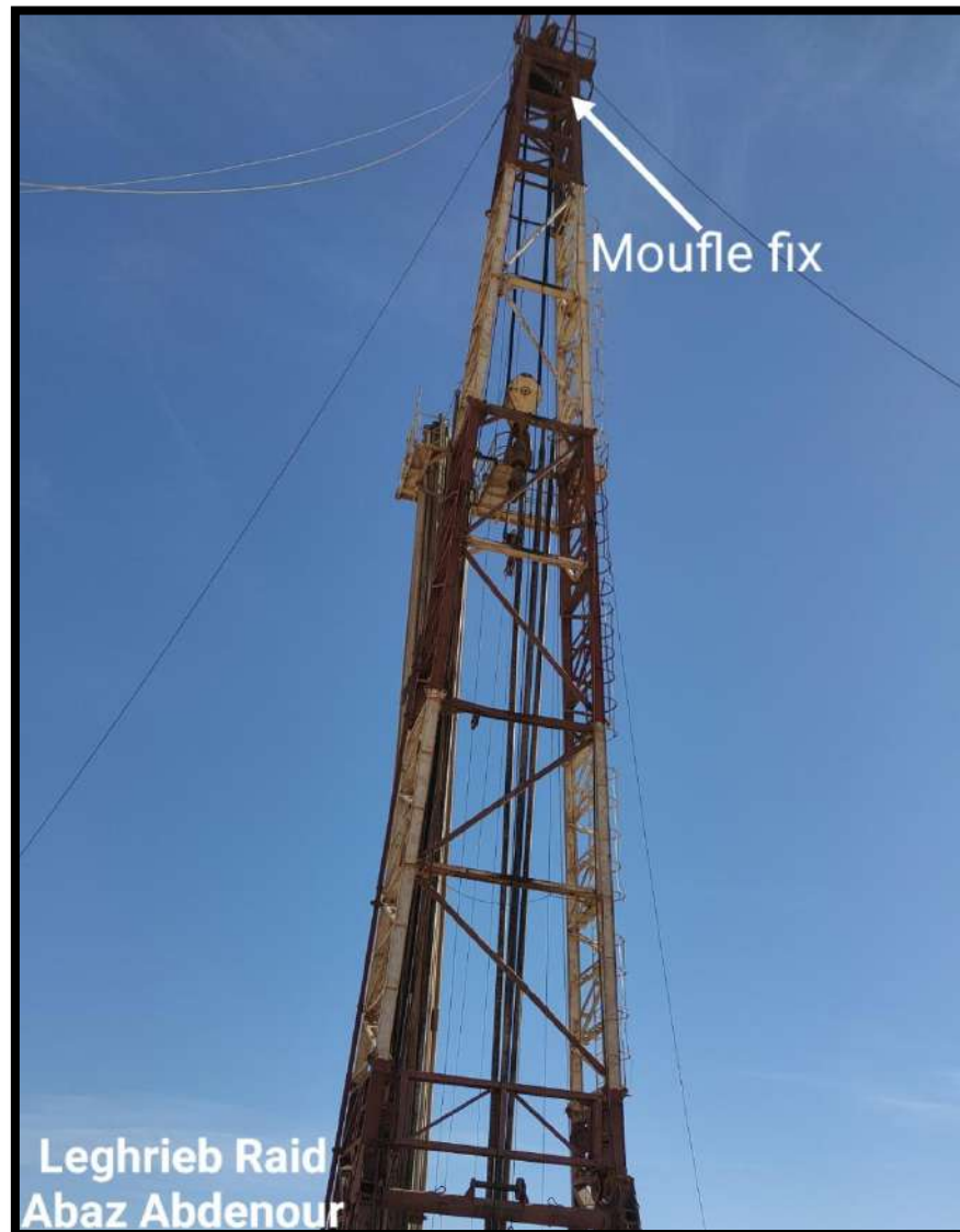
Photo N°4: Le moufle fixe ( crown block ).
