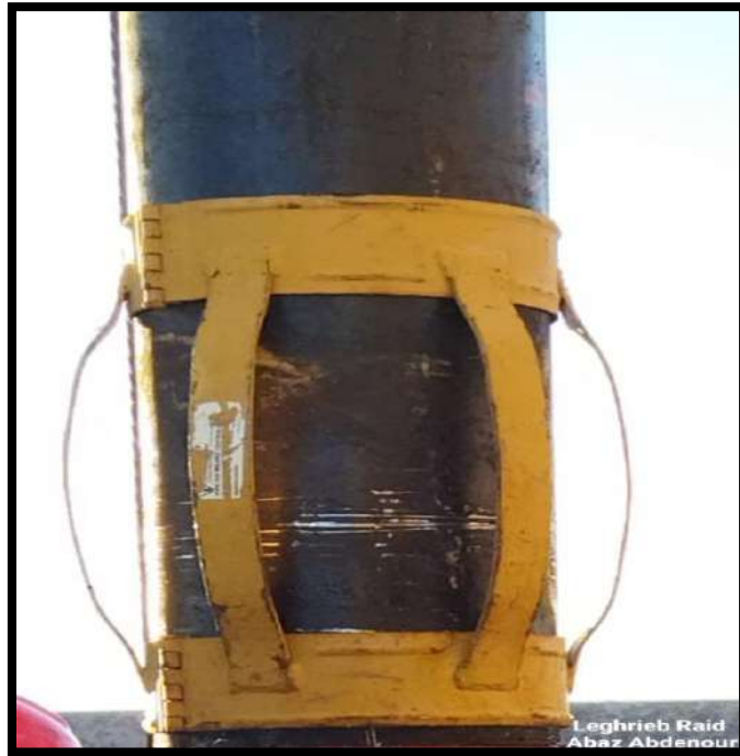
Photo N°32: Centreurs souples ( Tubage-Trou).
