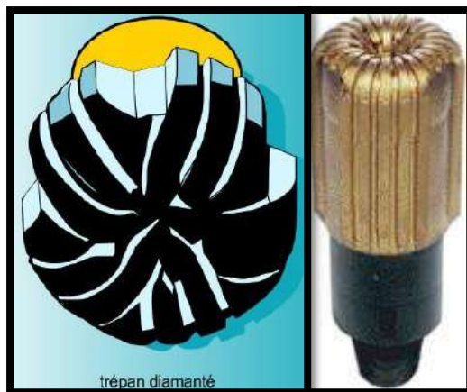
Figure II.11: Un outil à diamant naturel.
