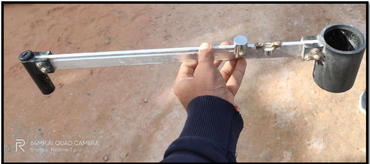
Photo N°17: Un densimètre (la balance à boue) sur chantier de forage [Taken by Leghrieb Raid et Abaz Abdenour 2022].
