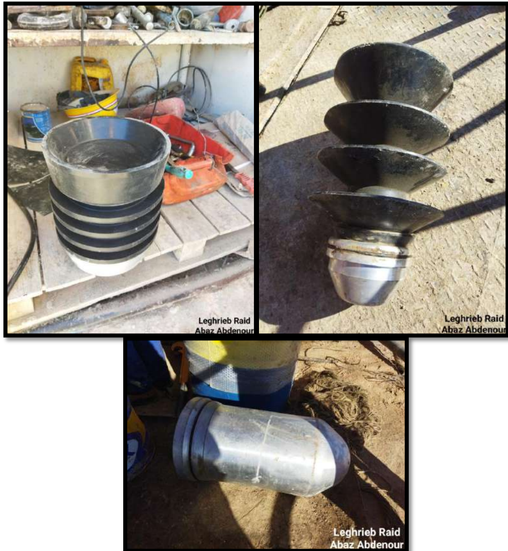
Photo N°31 Plugs and opening devices used to operate stage tools (Cimentation étagée équipement )
