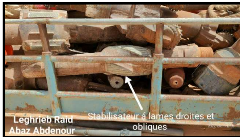
Photo N°13: Stabilisateur à lames droites et obliques.
