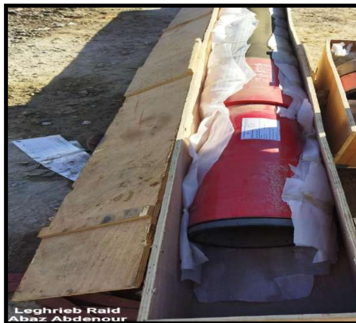
Photo N°33: Le packer ( Hydraulic Inflation Packer).
