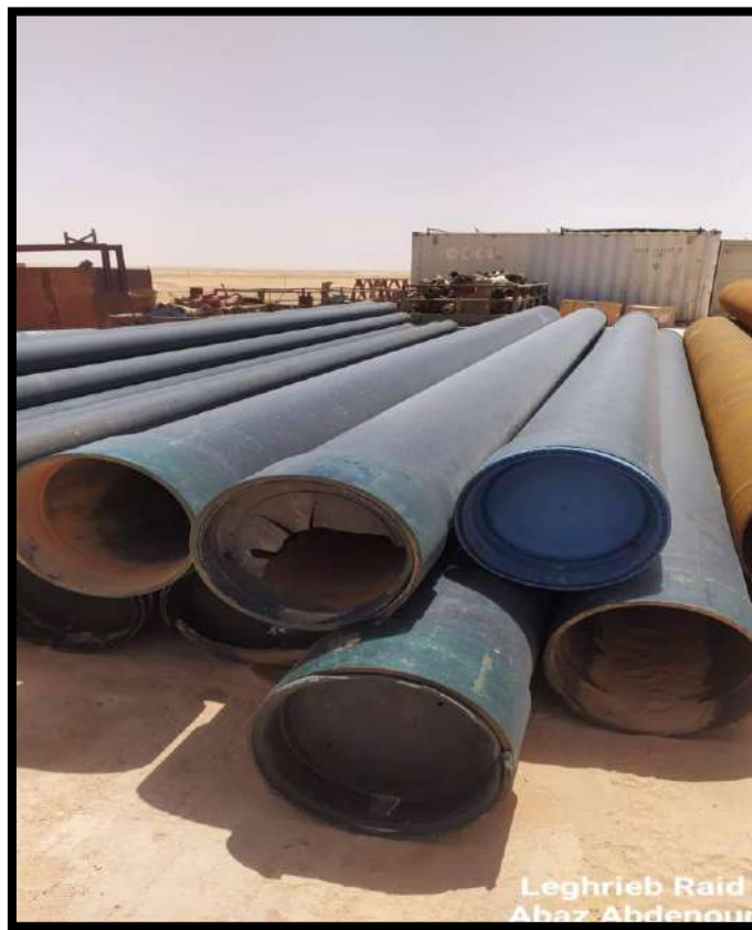
Photo N°27: Le Tubage 18 5/8 " API.
