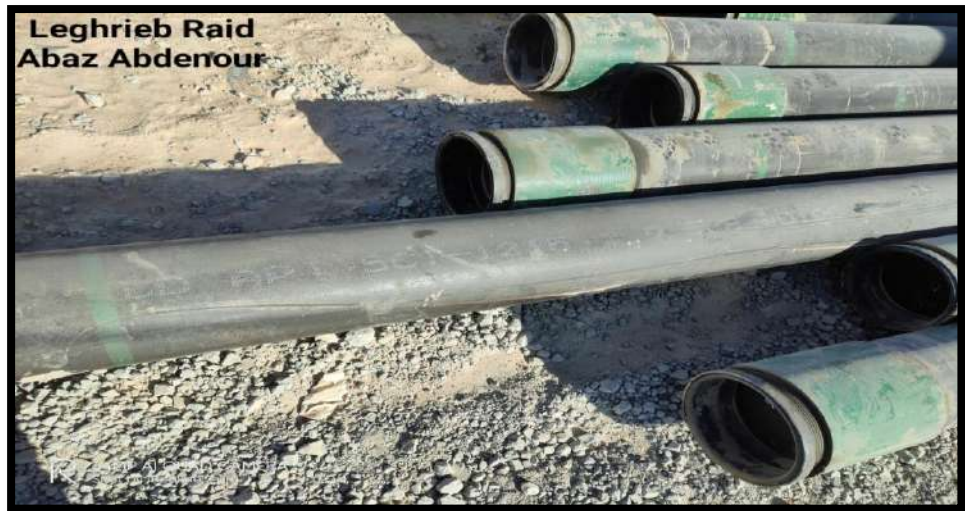
Photo N°28: Le tubage 9 5/8 " API.
