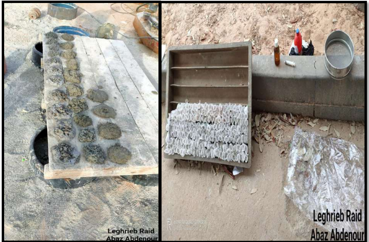
Photo N°23: Cuttings prélevés sur chantier après numérotés et conservés dans des sachets en plastique.
