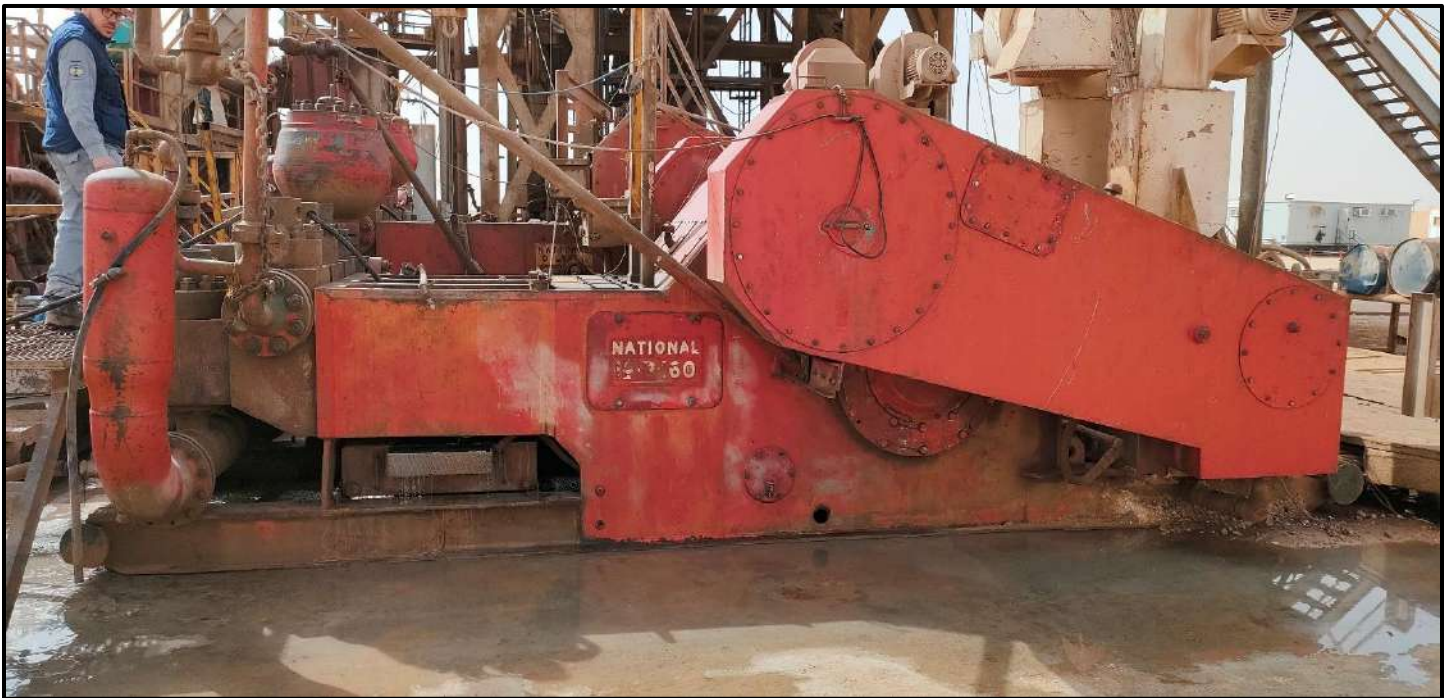
Figure II.3 : La pompe à boue NATIONAL-OIL-WELL 12P160
