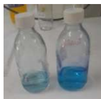
La solution de 2.5mg/l et après la 3 ème fois de filtration de composite 1.
