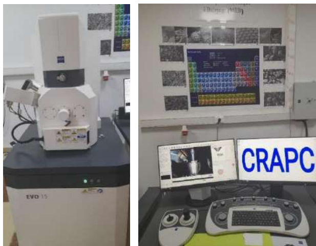
Figure II.21: Microscopie électronique à balayage équipée d'un détecteur EDS utilisé.
