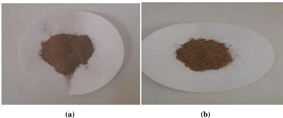
Figure II.12: la fibre du palmier dattier, (a) avant traitement (b) après traitement par NaOH.
