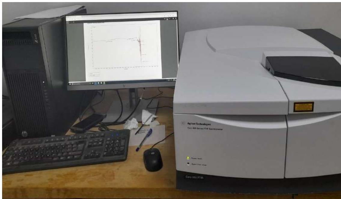
Figure II.18: Spectrophotomètre infrarouge utilisé (FTIR- ATR).
