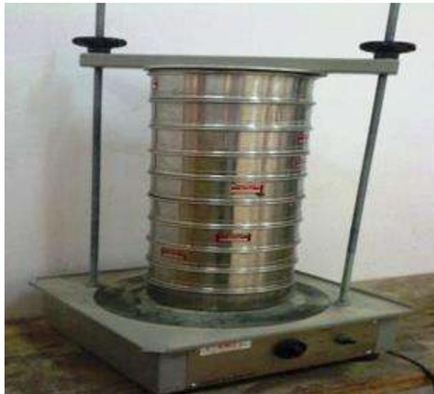
**Figure 03: Analyse granulométrique par tamisage.**
