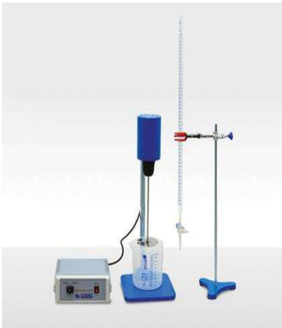
Figure 06 : Appareil de bleu méthylène.
