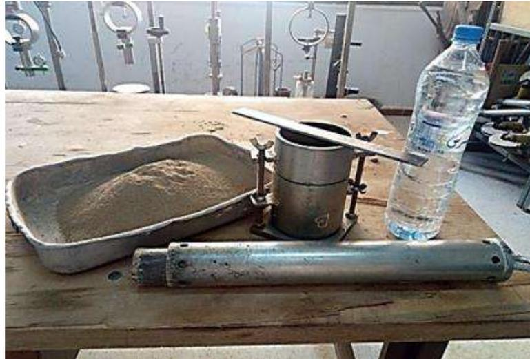
**Figure 08: Matériel de Proctor.**
