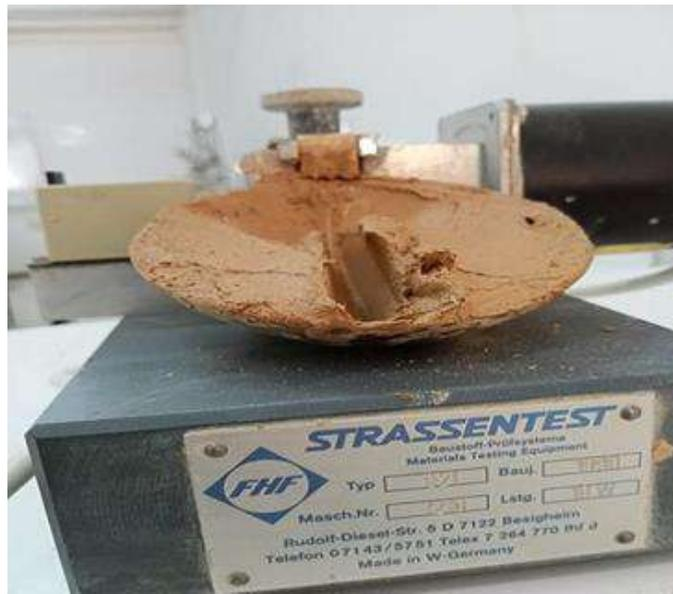
**Figure 05: Appareil de Casagrande.**
