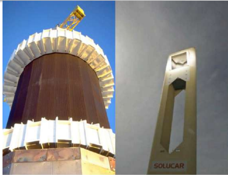
Figure 2.10 : Deux exemples de récepteurs pour la tour solaire : (à gauche) le récepteur externe, (à droite) le récepteur à cavité [13].
