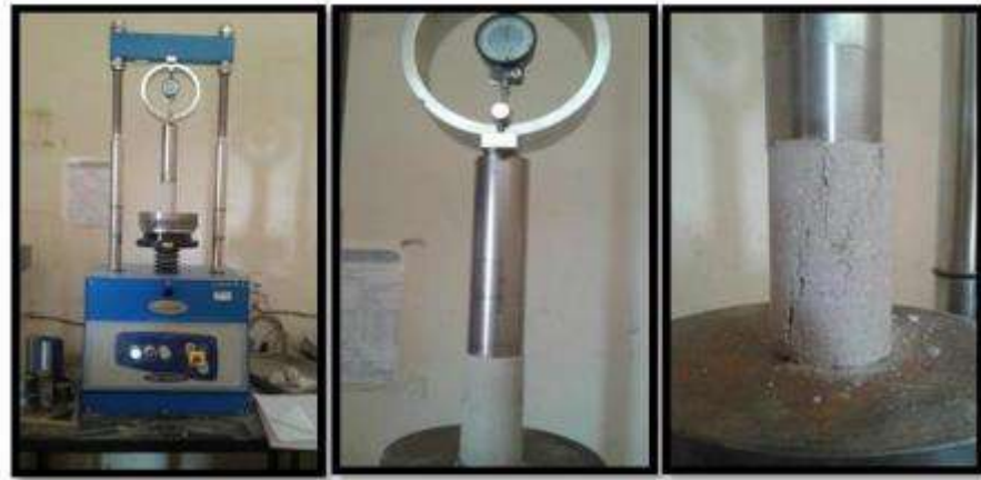
PhotoIII.9.: Ecrasement des éprouvettes dans Presse CBR
