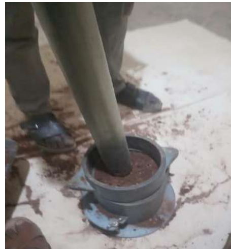
Photo III.4. : Opérations de l'essai Proctor.
