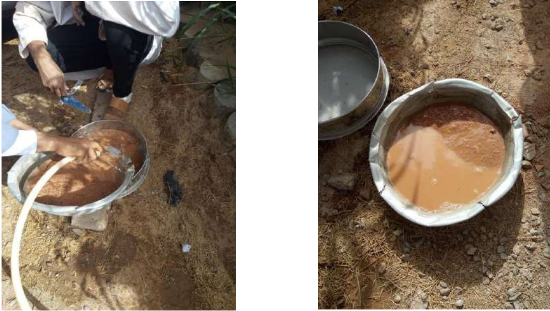
Photo III.3. : Mode Opérateur Analyse granulométrique de argile.
