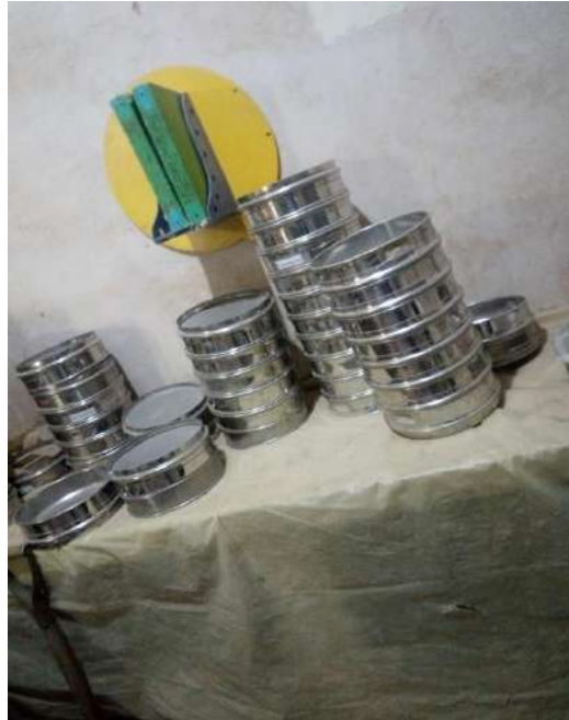
Photo III.2. : Appareillage pour l'essai Analyse granulométrique.
