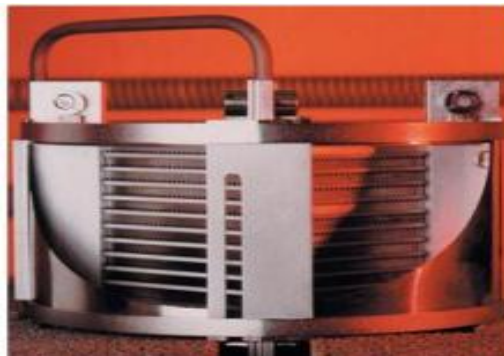
Figure 1. 17 Prototypé de pile SOFC réalisé au centre de recherches de Jülich en Allemagne. [38]
