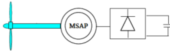
Figure 1. 6 Aérogénérateur à aimants débitant directement à travers un pont de diodes sur le bus continu. [19]
