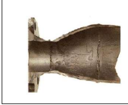
الشكل (I - 7) : صورة لتآكل بالتعرية [11]
