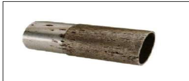
الشكل (I - 3): صورة لتآكل الموضعي [11]
