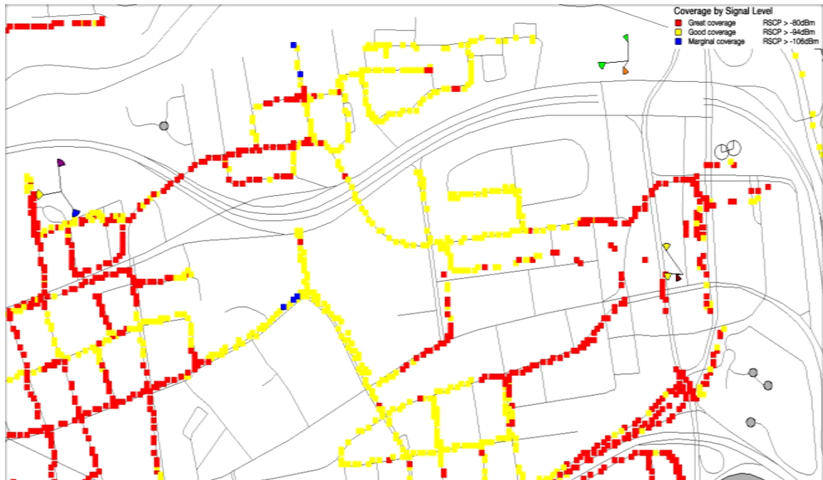
Figure 36 : Trace d'une mesure Drive-test
