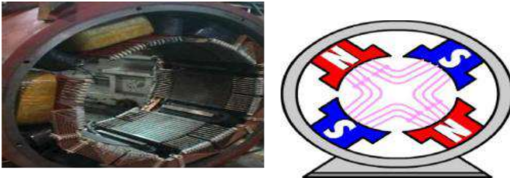
Figure (I.3) : l'inducteur de la machine à courant continu
