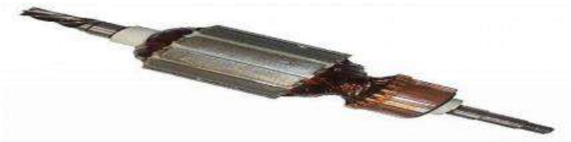
Figure (I.4) : L'induit de la machine à courant continu
