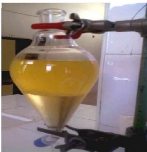
FigIV.3 : Photo de séparation des phases
