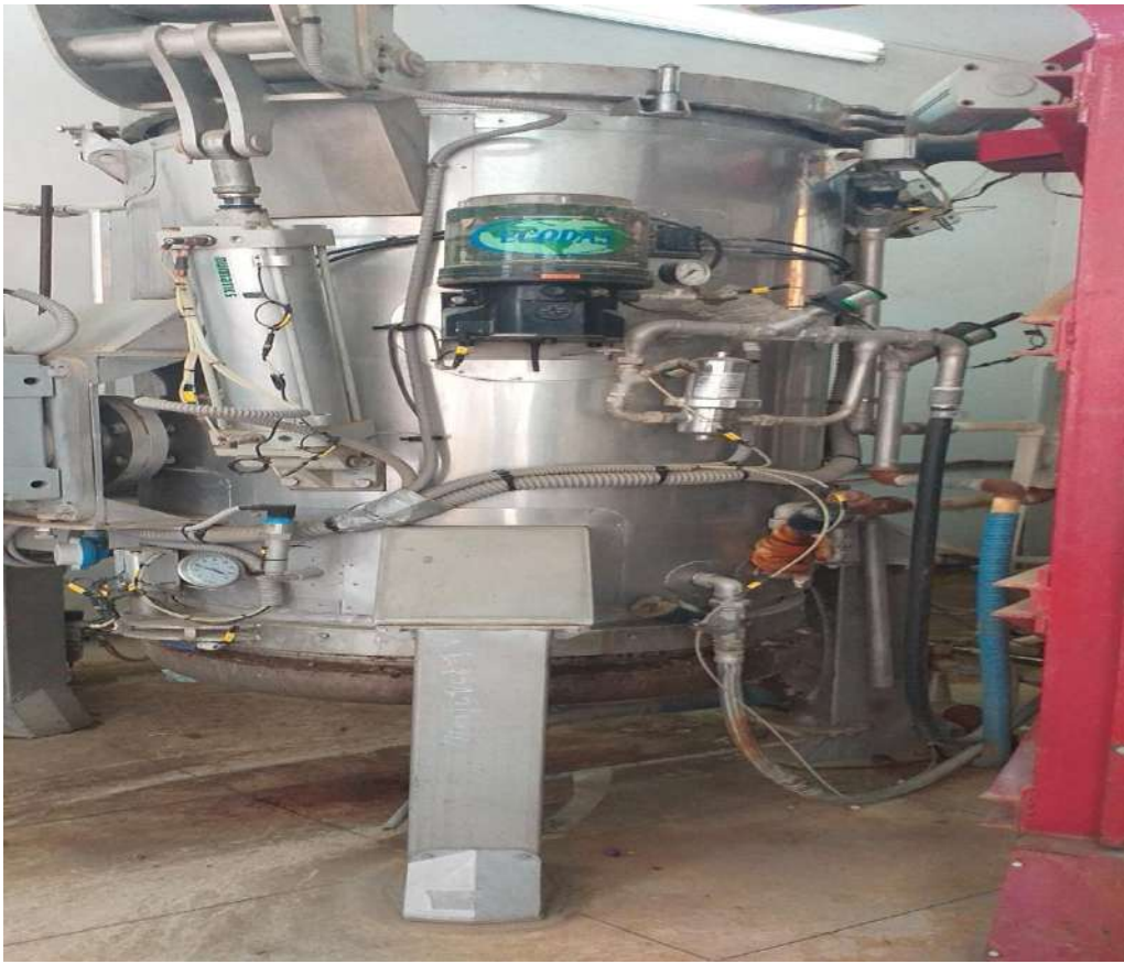
الصورة رقم (06) : توضح آلة التفتيت للنفايات الطبية
