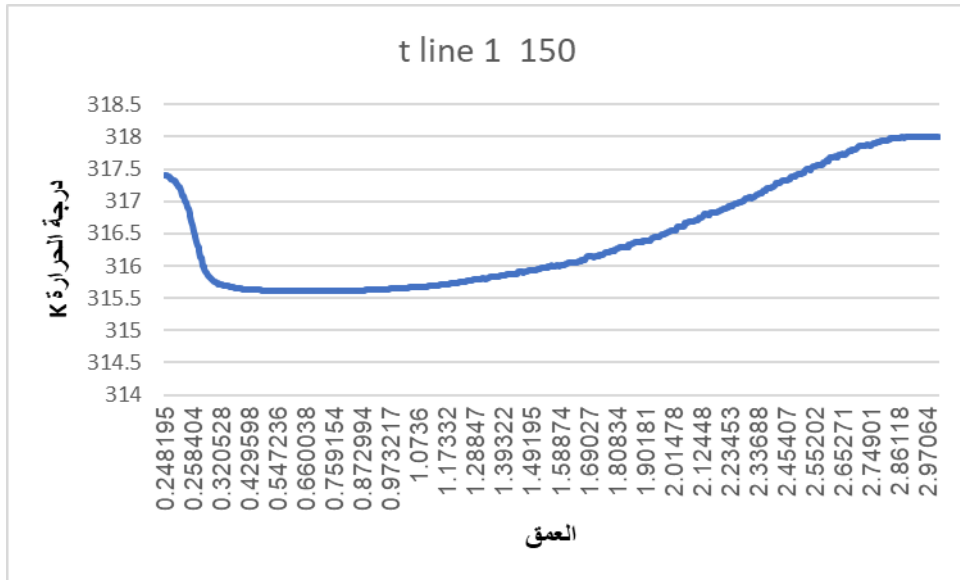
الشكل 3-13: ملامح درجة حرارة الهواء لـ L 20m D 150 و Re 1000
