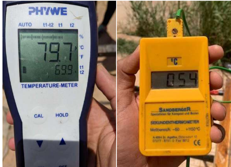
Figure IV.1 : les Instruments de Mesure de la température (thermocouples).
