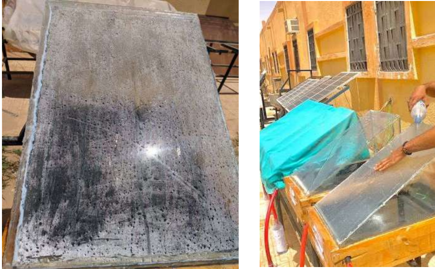
Figure IV.5 : refroidissement manuel du vitrage.
