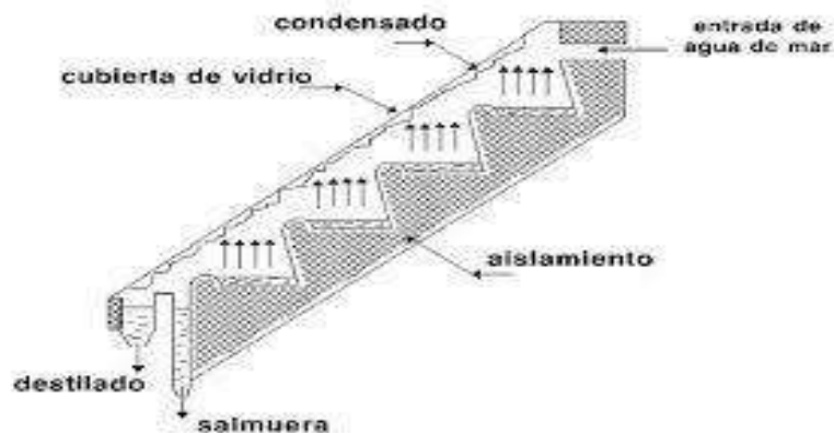
Figure II.12 : Distillateur solaire incliné à cascades. [51]
