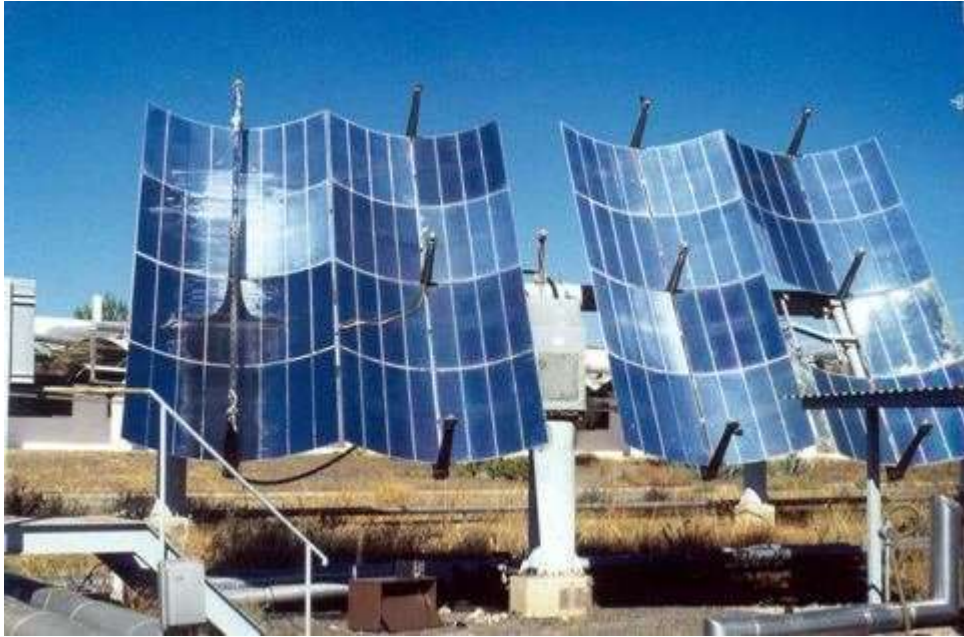
Figure II. 5 Concentrateur en auge parabolique doté d'un système de suivi du soleil à deux axes, installé sur la plate forme solaire d'Almería en Espagne [36].
