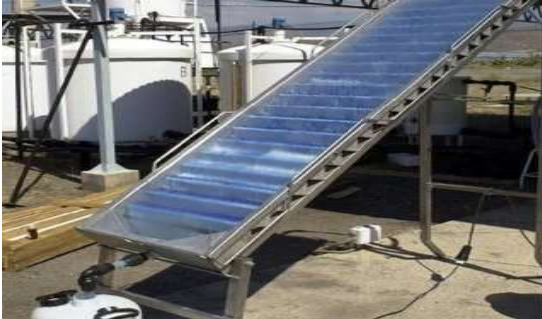
Figure II.4 collecteur à non-concentration de type cascade utilisant le catalyseur supporté Ahlstrom (plate forme solaire d'Almeria, Espagne) [34].
