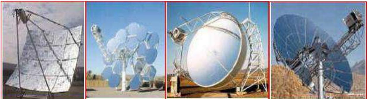
**Figure II.1.** Nombreux prototypes de concentrateurs paraboliques [26]
