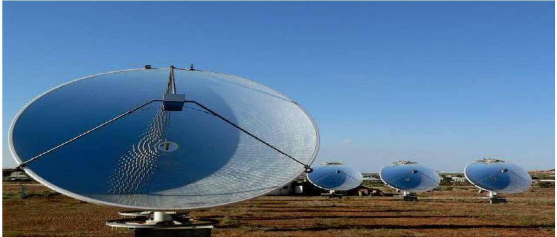
**Figure II.2.** Concentrateurs paraboliques [25]
