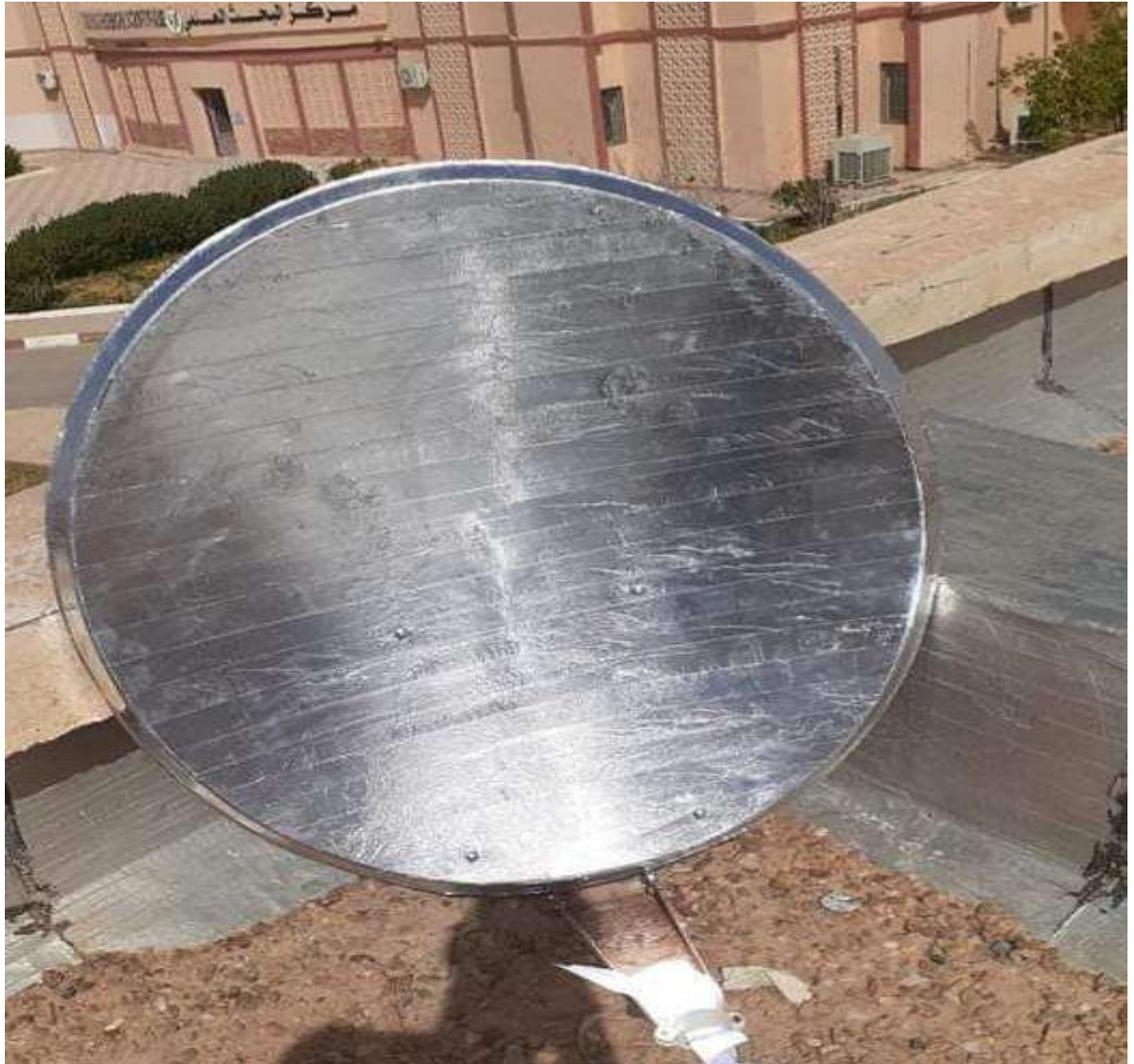
**Figure IV.3** parabole recouvertes d' une feuille d' aluminium
