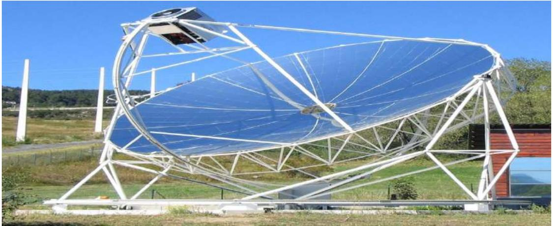
**Figure II.8.** *Système Parabole-Stirling [39]*
