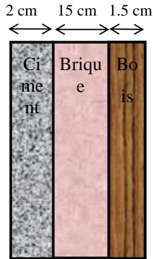
Figure 13 : mur typique n°03
