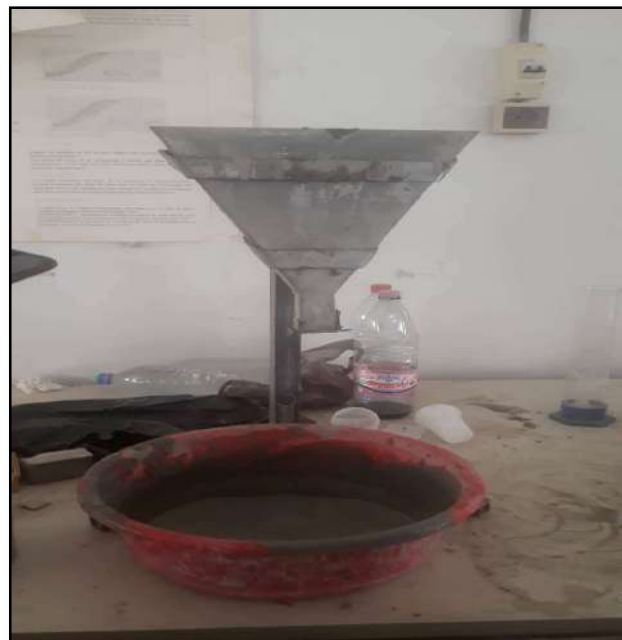
Figure (I.8) : Essai De Déformabilité De l'Entonnoir En V (V-Funnel).
