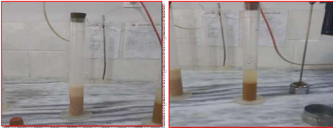
Figure III.3 : Essai d'équivalent de sable.
