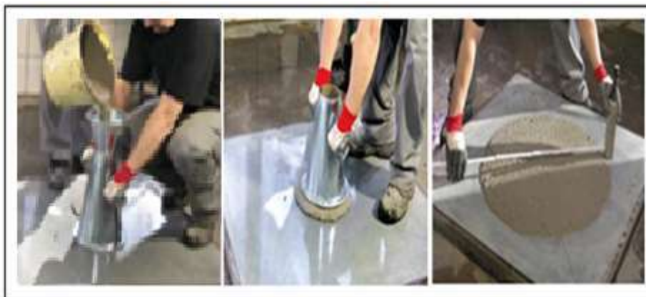
Figure (I.4) : Détermination de l'étalement
