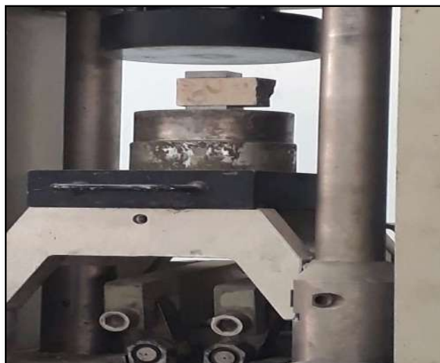
Figure (I.10) : Essai de la résistance à la compression
