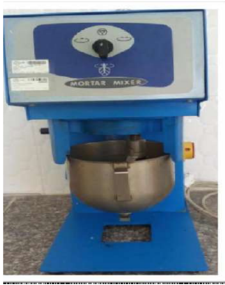
Figure III.3 : Malaxeur pour mortier
