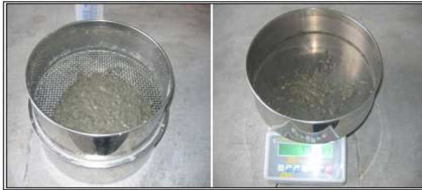
Figure (I.6) : Essai de stabilité eu tamis
