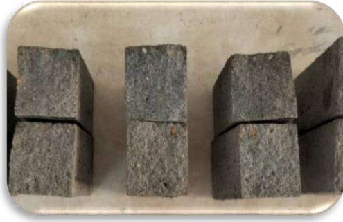
صورة (18-3-): أنصاف العينات الناتجة من اختبار الانحناء
