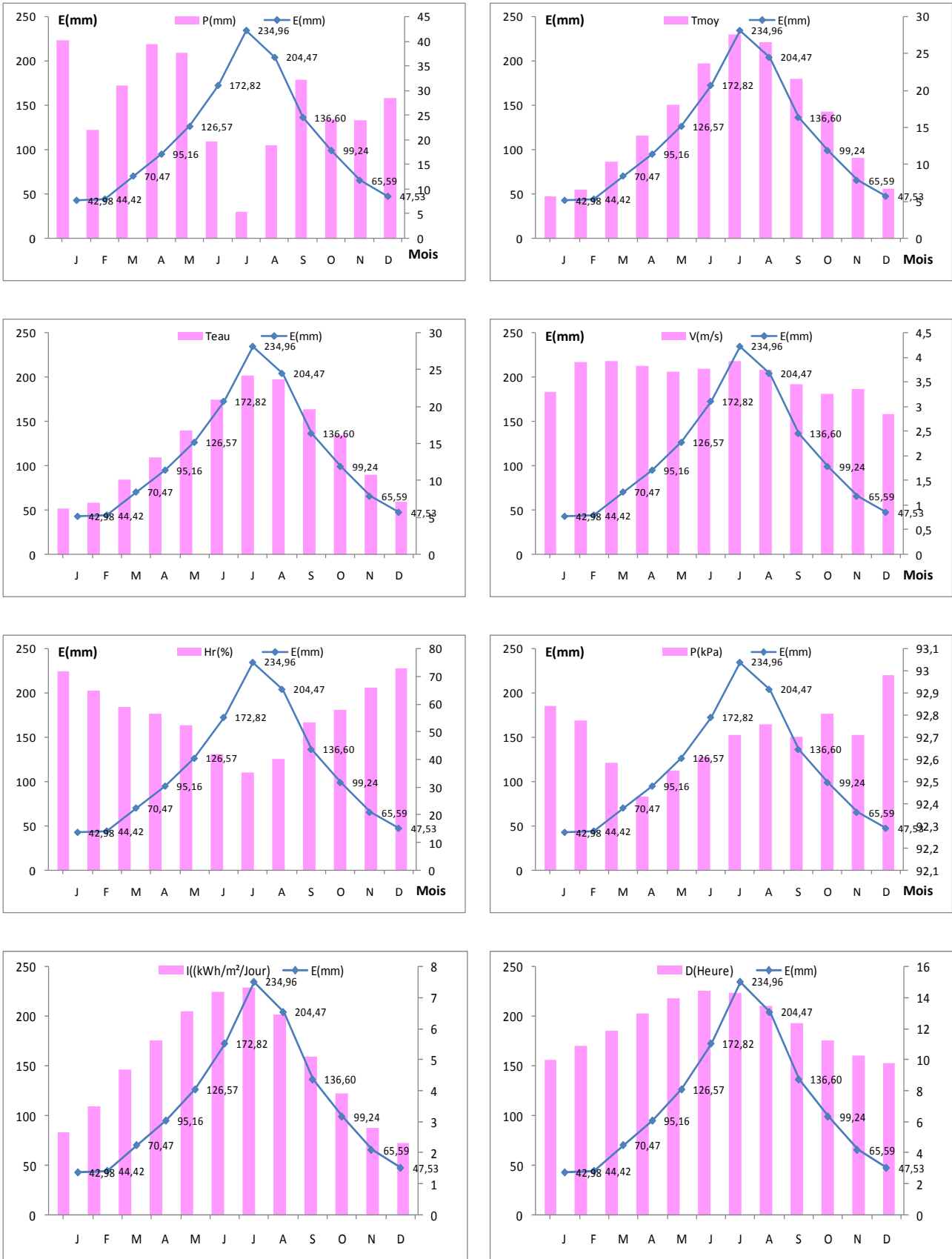
Figure II. 6. 19. Variation de l'évaporation de l'eau du barrage –réservoir Fom El-Guies-Khenchela avec les paramètres climatiques existants : P(mm), T air (°C), T eau (°C), V(m/s), H r (%), P(kPa), I(Kwh/m²/J) et D(Heures).
