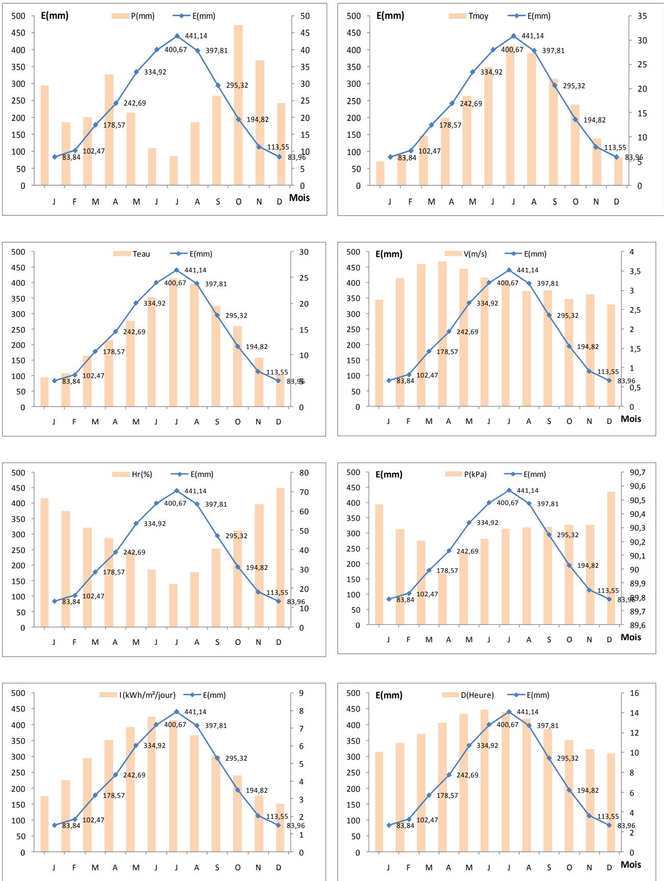
Figure II. 19. Variation de l'évaporation de l'eau du Barrage Brézina avec les paramètres climatiques existants : P(mm), T air (°C), T eau (°C), V(m/s), H r (%), P(kPa), I (Kwh/m 2 /J) et D(Heures).
