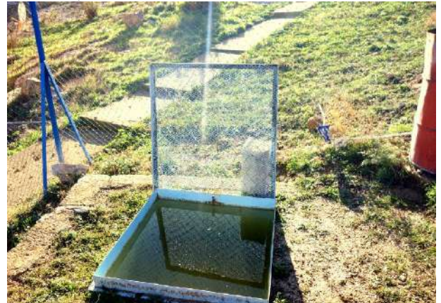
f) Mesure de l'évaporation au niveau du bac Colorado- Foum El-Guies
