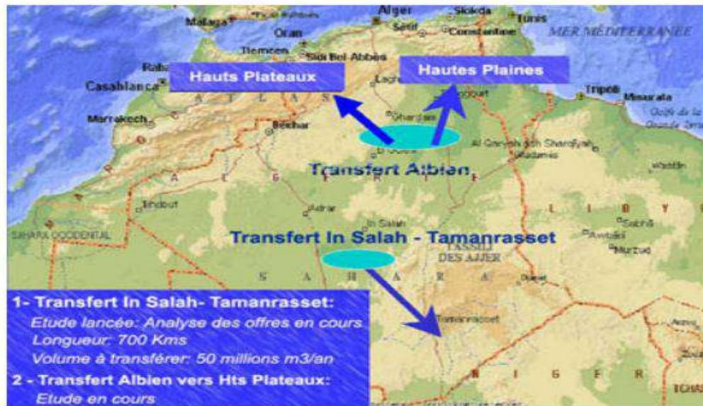
Figure (4.5) : Transfert des eaux des nappes profondes du Sahara.
