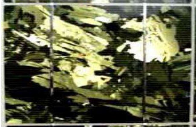
**Figure (1.21) :** Cellules poly cristallines.
