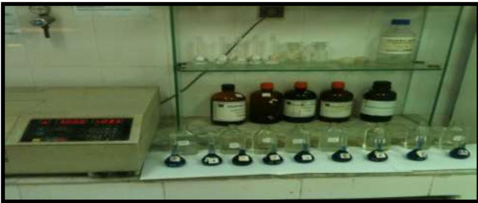
Contrôle de la concentration de l'anti-Dépôt par le spectro-photomètre UV-Visible.
