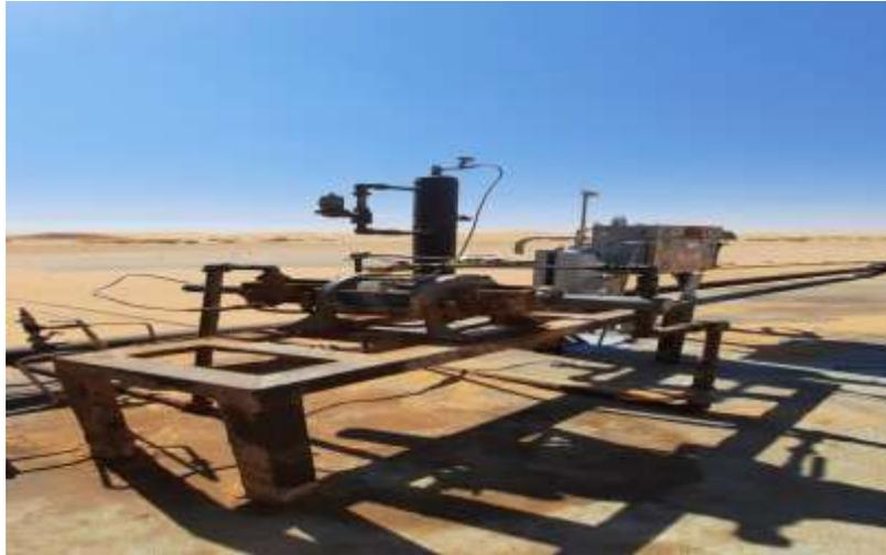
Figure III.3 : Une pompe BSB alimenter par Scrubber.
