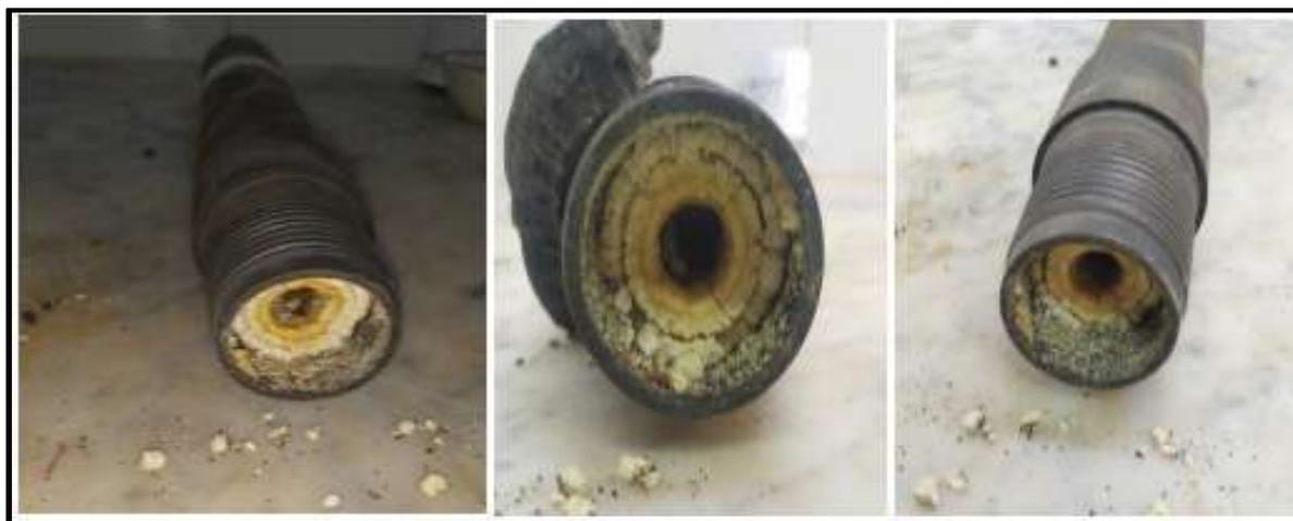
**Figure IV.8 :** représente le dépôt de produit de traitement puits OMP70.
