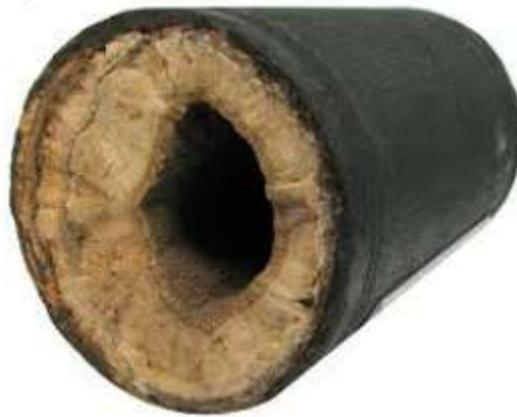
**Figure II.4 :** Dépôts de  $\text{CaSO}_4$  dans une pipe de pétrole. [6]
