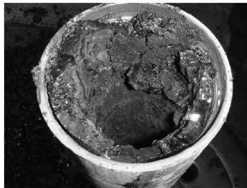
Figure II.9: La disposition des asphaltènes dans de tubing de production [23].
