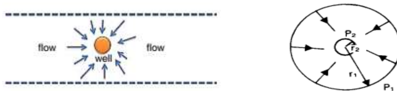
Figure II.2: Système d'écoulement Radial circulaire [15]
