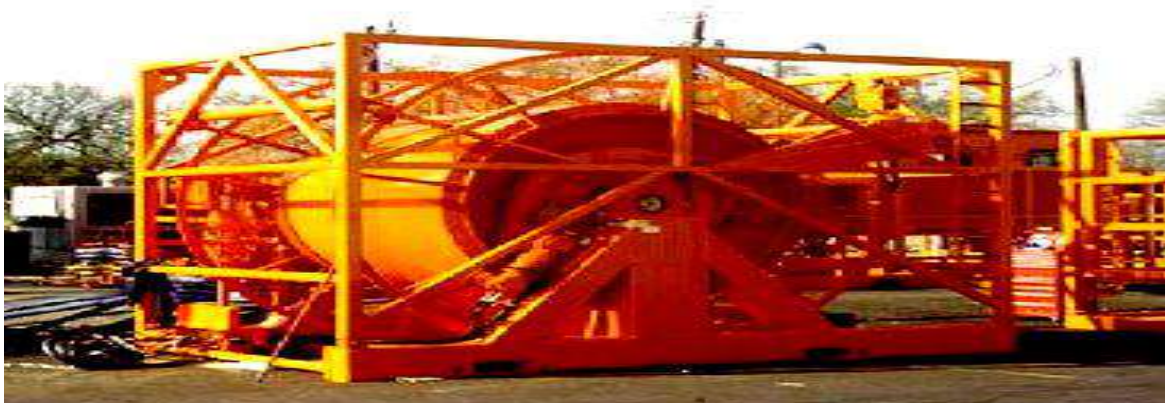
Figure II-7 : Tambour du treuil
