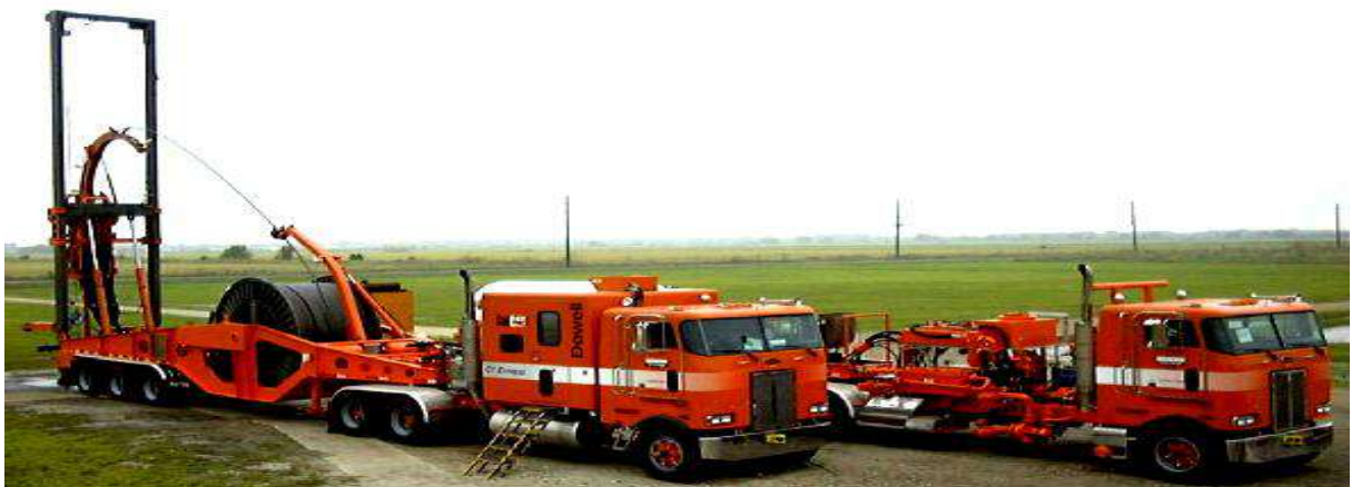
Figure II-5 : Unité de coiled tubing et unité de pompage
