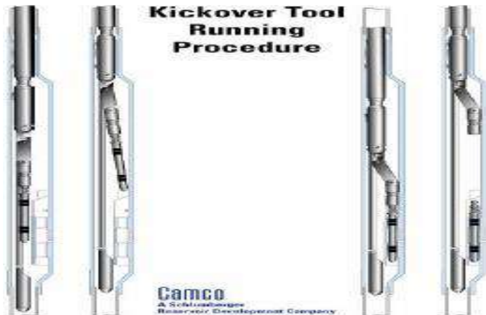
Fig II-9: Opération de mise en place d’une vanne de GL par un kickover [5]
