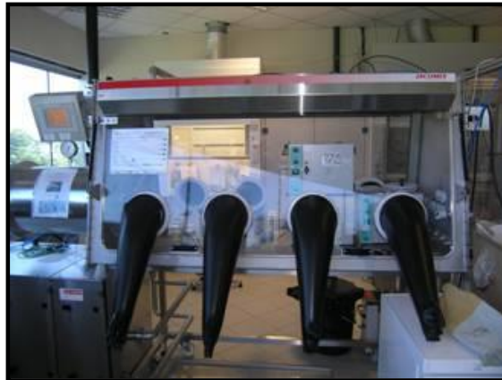
Figure 5. 9: Boite à gants utilisée pour le vieillissement des polymères en atmosphère inerte contrôlée saturée en argon (labo 6 technique puits).
