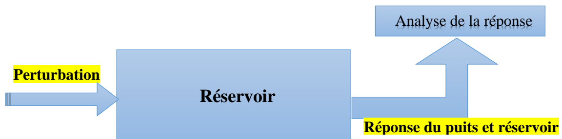
Figure I-1 Principe des essais de puits
