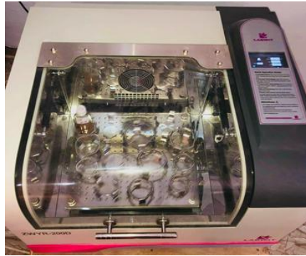
Agitateur incubateur, LABWIT ZWYR-200D
