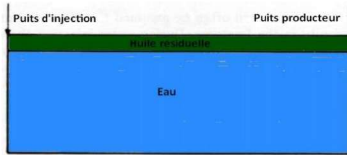
Figure II.4: Illustration de l'état des fluides dans le réservoir « après l'injection d'eau »
