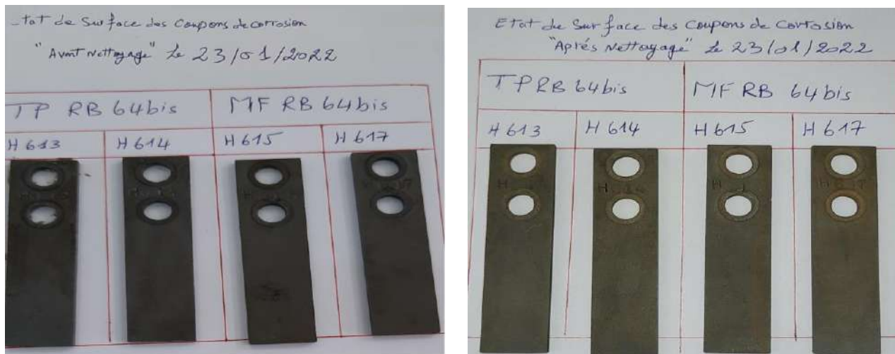
Photo III.8: Etat de surface des coupons de corrosion extraits au niveau du puits RB64bis avant et après le nettoyage
