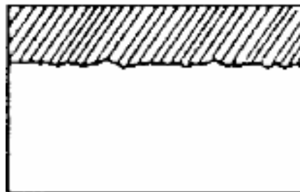
Figure I.1 : schéma de corrosion uniforme
